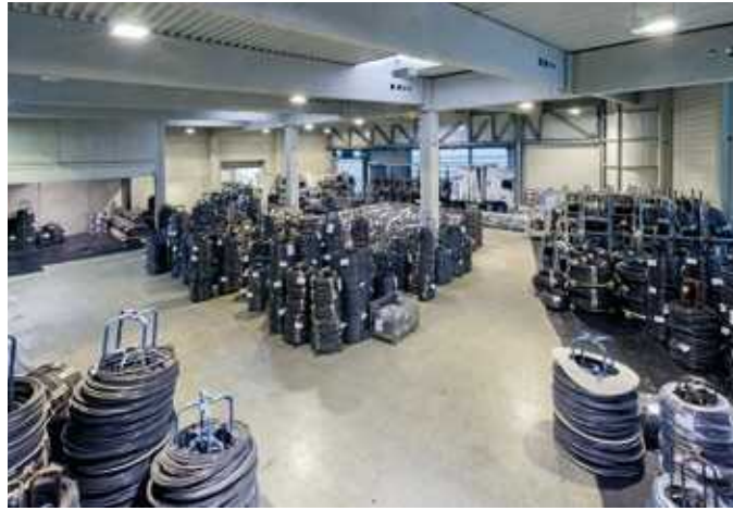
Die Firma Klincke produziert im unteren Rahmedetal Draht für Wälzlager (Foto). Fünf Mal wird gegläht und gezogen. Im Werk Claas ganz oben in der Rahmede werden Kaltstauchdrähte für Muttern und Schrauben gezogen. / Klincke produces wire for roller bearings in the lower Rahmedetal (photo). The wire is annealed and drawn five times. Cold heading wire for nuts and bolts is drawn at the Claas plant at the top of the Rahmede.
